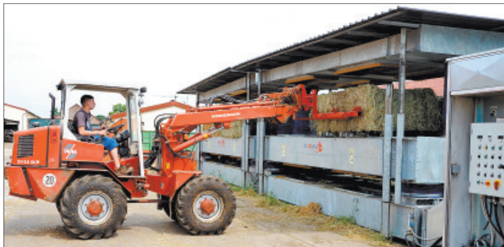
Die Beschickung und Entnahme der Ballen erfolgt mit einer speziellen dreizinkigen Gabel am Radlader. Die Lüftungskanäle der Trocknungsanlage lassen sich dafür in der Höhe verstellen.
